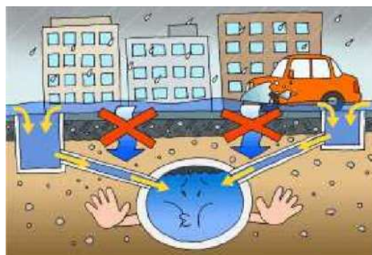
図 バックウォーター現象のイメージ 出典：国土交通省「大規模広域豪雨を踏まえた水災害対策のあり方について」2018年
