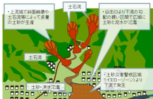
図 土砂・洪水氾濫のイメージ 出典：国土交通省HP「(土砂・洪水氾濫)」
