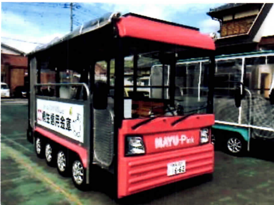
「グリーンスローモビリティ：電動で、時速20km未満で公道を走る、4人乗り以上のモビリティ」
