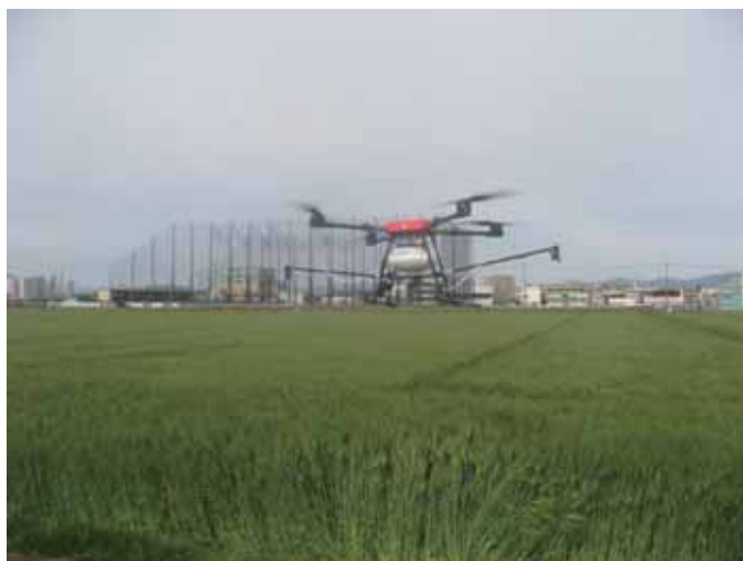
▲ 麦畑に農薬を散布するドローン
