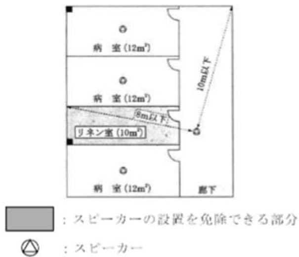
第6図【居室又は居室から地上に通じる主たる廊下その他の通路以外の場所でスピーカーの設置を免除できる場所】
