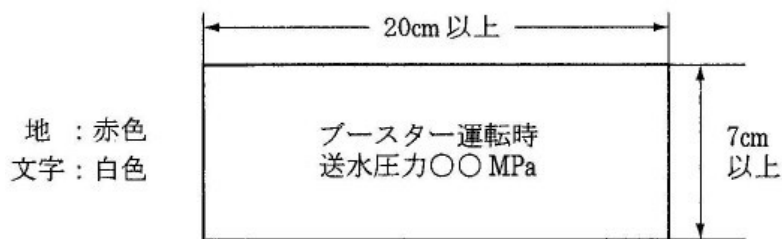
第6図【加圧送水装置を設置した場合の設計送水圧力の標識例】
