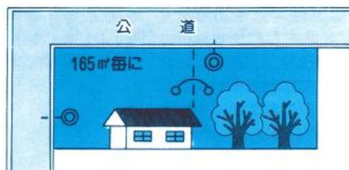
☆上記の基準内で汚水ますを設置した場合は、取付管の工事費は市が負担します。基準を超えて汚水ますを設置した場合、取付管の工事費が個人負担となります。
