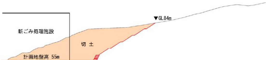
図 3.4-14 切盛土の計画断面図
