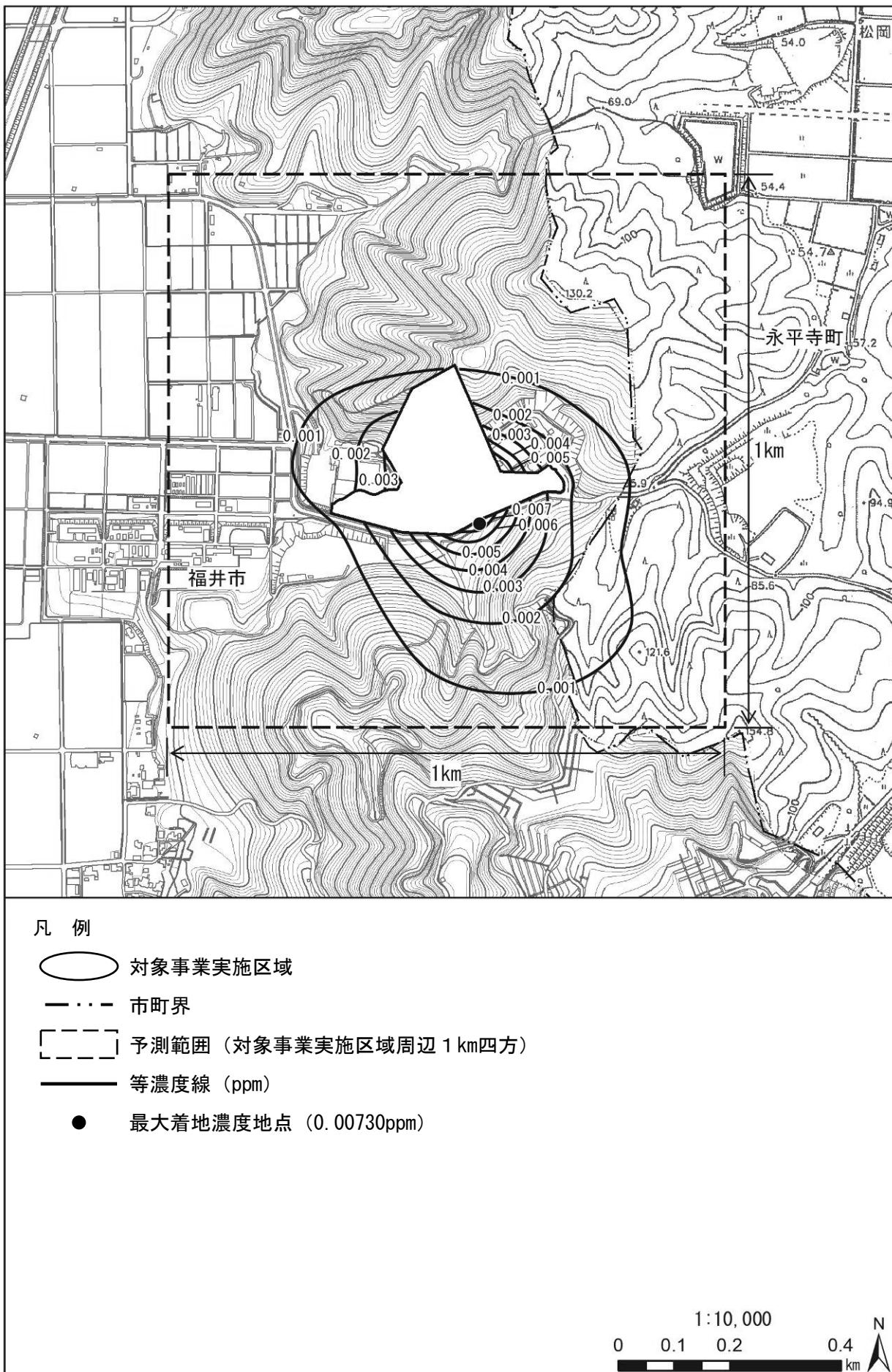
図 8.1-1(1) 建設機械の稼働に伴う大気質予測結果（二酸化窒素）
