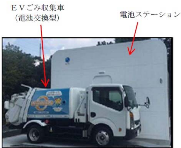
EVごみ収集車(手前)と電池ステーション(奥)
