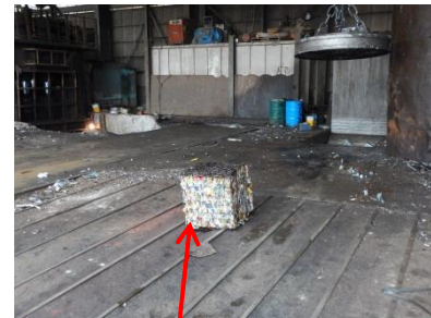
空き缶を自社プレス機でブロック状の塊に加工し、製鉄業者に売却。
