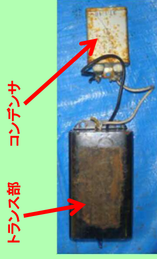
①コンデンサ露出型 タイプ (コンデンサ別置きタイプ)
