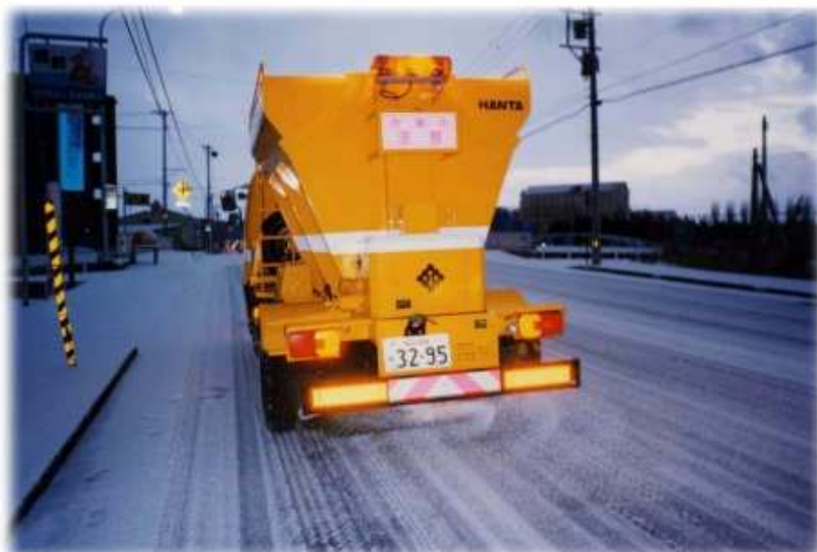
凍結防止剤散布状況
