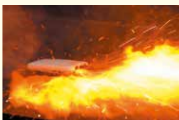
モバイルバッテリーの発火（再現実験） NITE 提供
