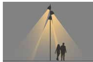
路面の明るさを高める スポットライトポール照明
