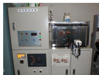
毒物監視装置
