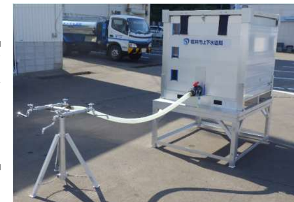
【給水コンテナ】
