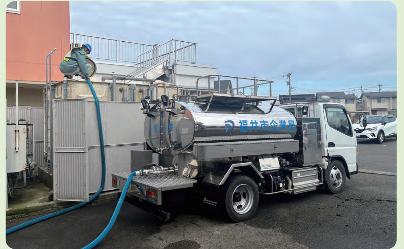
派遣先での受水槽への給水の様子
