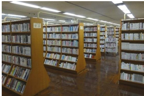
中置書架：柱間隔は 6\text{m} \times 1/3 = 2\text{m} ピッチで余 裕があるものの、裾広がり型のため高書架上 部の資料が取りづらい
