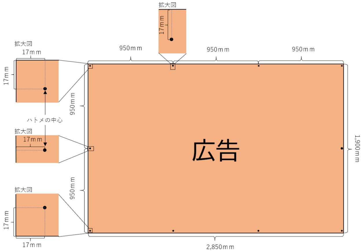
(6) 固定方法 布のハトメに針金を通し、壁面のビスに結び付けて固定すること。
