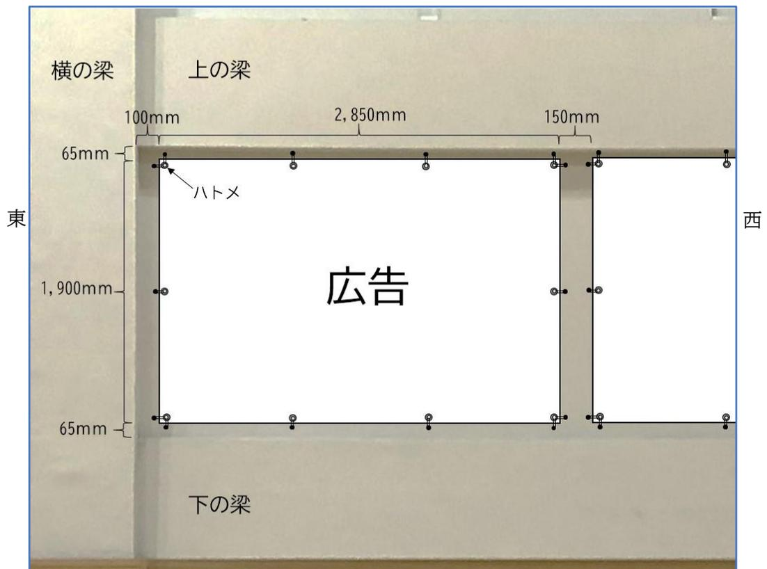
(5) 材質 ターポリンなどの幕 (600g/m<sup>2</sup>以下のもので安全性を確保できればよい)
