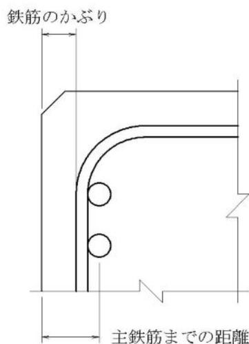
図 1 - 3 - 1 鉄筋のかぶり
