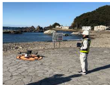
新技術を活用した漁港施設等の点検
