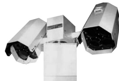
雪が降っているかどうかを観測する従来のセンサーとは異なり、「NEWロード・アイ」は、道路に直接光を当てて反射状態を調べるため、道路の積雪状況などを観測することができます。正確に融雪装置を稼働させることで効率的な融雪が可能になり、融雪装置の節電・節水効果も得られます。
