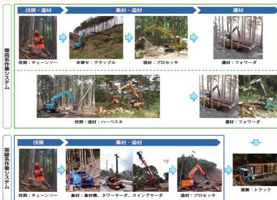
資料Ⅱ-37 我が国における高性能林業機械を使用した作業システムの例
