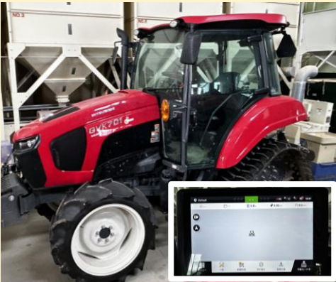
▲自動操舵トラクター（上）と車載操作モニター
