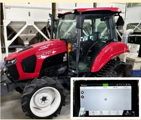
▲自動操舵トラクター（上）と車載操作モニター
