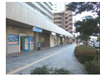
△1階部分をセットバックして歩行者空間を提供している例
